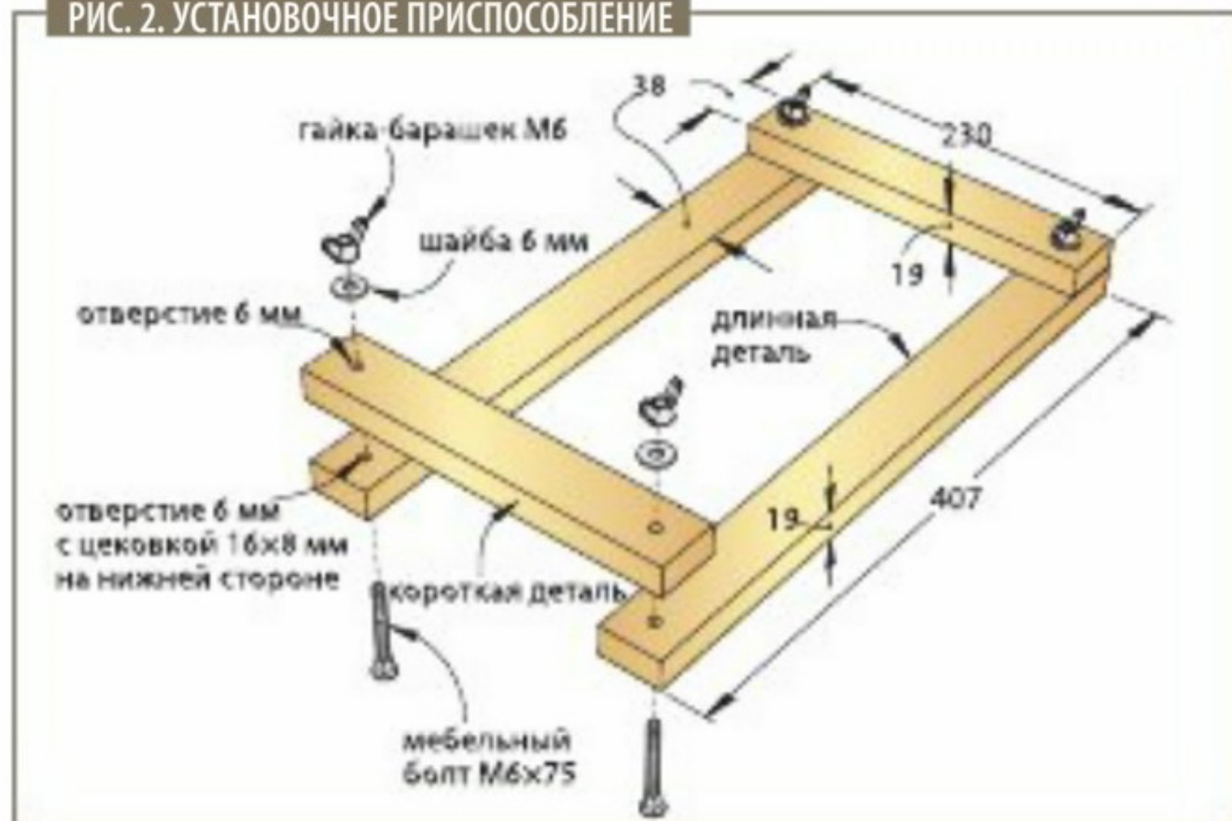
РИС. 2. УСТАНОВОЧНОЕ ПРИСПОСОБЛЕНИЕ
