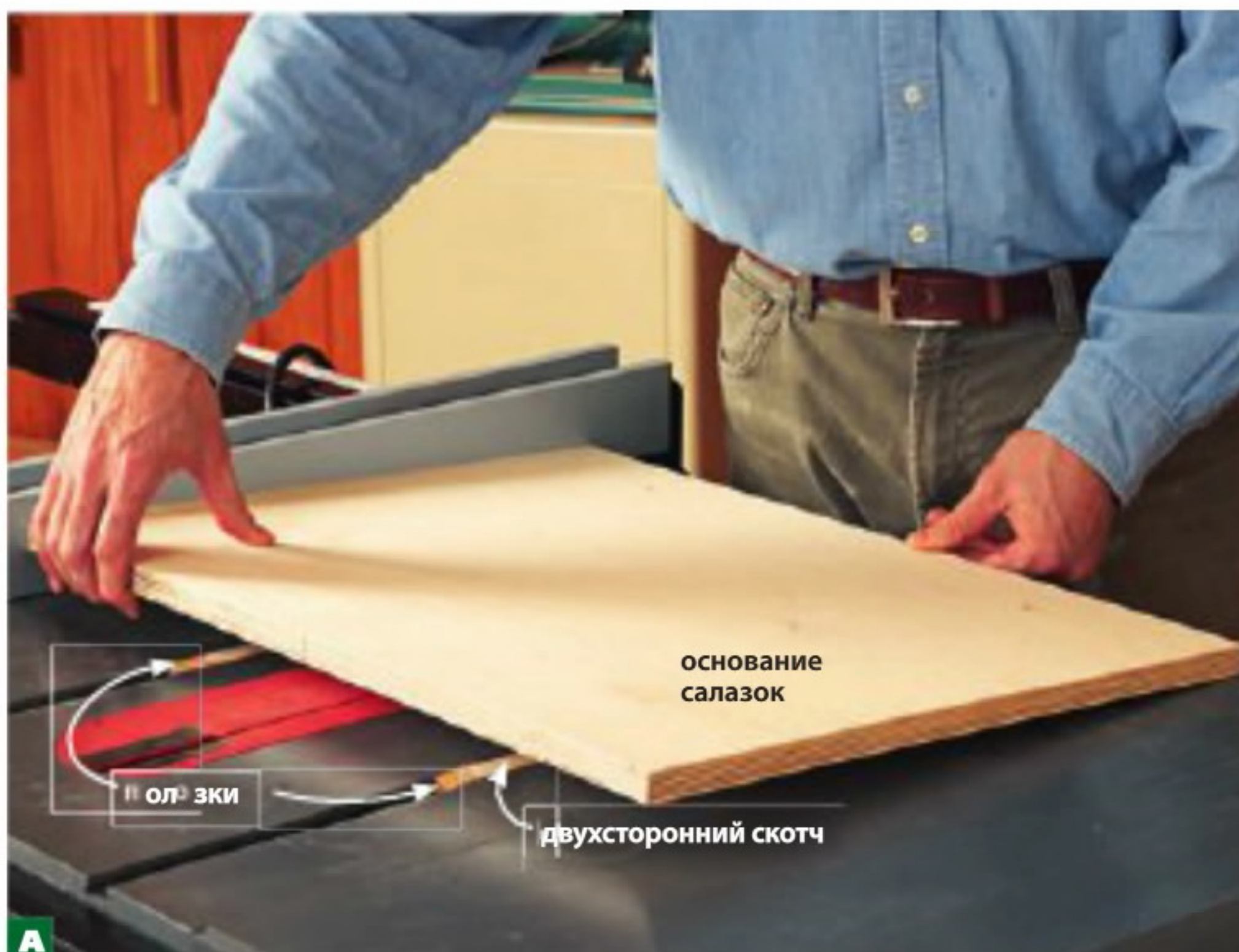
А Наклейте на полозки двухсторонний скотч и выровняйте их в пазах по переднему краю пильного стола. Прижмите один край, слегка наклонив фанерное основание, прижмите один его край к продольному упору, а затем опустите вниз, чтобы приклеить к полозкам.
