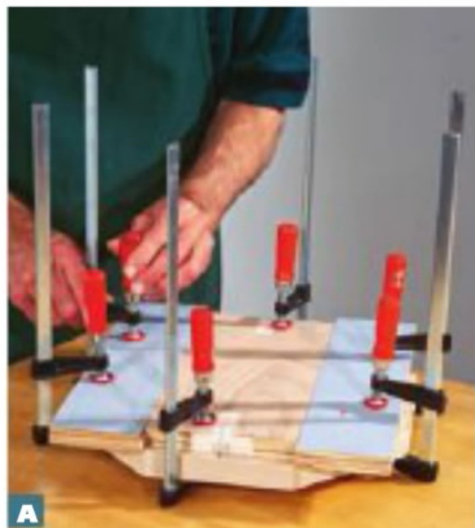
A Разметьте центры на торцах фанерного шаблона, выровняйте метки с первой диагональю заготовки и струбцинами закрепите направляющие обрезки.
