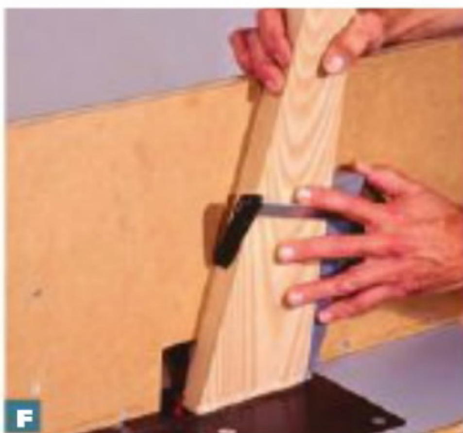
F Сделав пробные проходы на обрезках, отфрезеруйте трапециевидные гребни вдоль верхних скосов ножек. Высокий упор и толкатель помогут сделать это аккуратно.
