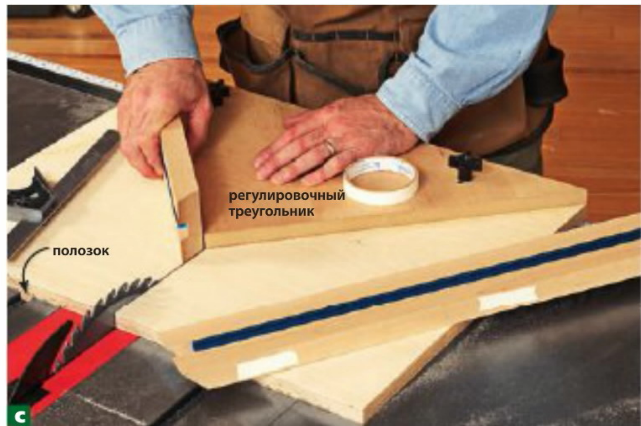
Упоры приспособления временно зафиксированы на месте двухсторонним скотчем, пока вы проверяете правильность их установки, делая пробную рамку из обрезков. Кончик упора вначале должен слегка прикрывать пропил в основании. Алюминиевый профиль с Т-образным пазом сдвинут к заднему концу упора.
