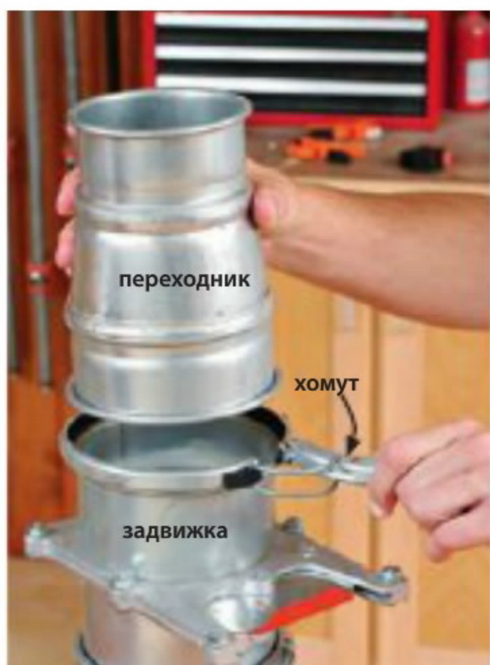
Этот конический переходник служит для подсоединения гофрированного шланга или узкой трубы. Хомуты с защелками позволяют быстро собрать систему или разобрать ее для ремонта и обновления.
