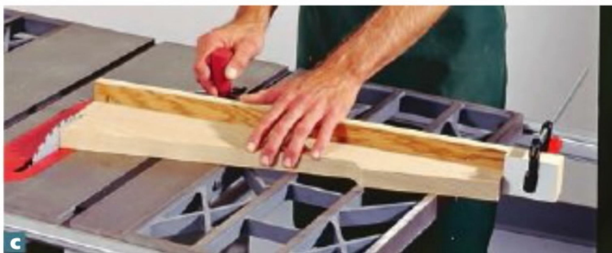
С Настройте поперечный упор на угол 6^\circ и опилите скосы на верхних концах ножек. Затем переставьте упор в другой паз пильного стола и опилите нижние концы ножек.
