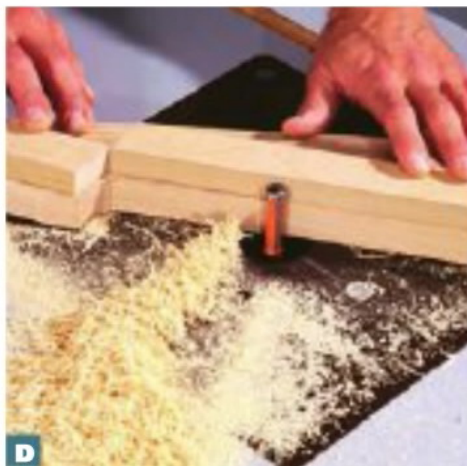
D Двухсторонним скотчем приклейте направляющие обрезки и обработайте копирующей фрезой внутренний край одной ножки. Затем используйте ее как шаблон для обработки остальных ножек.
