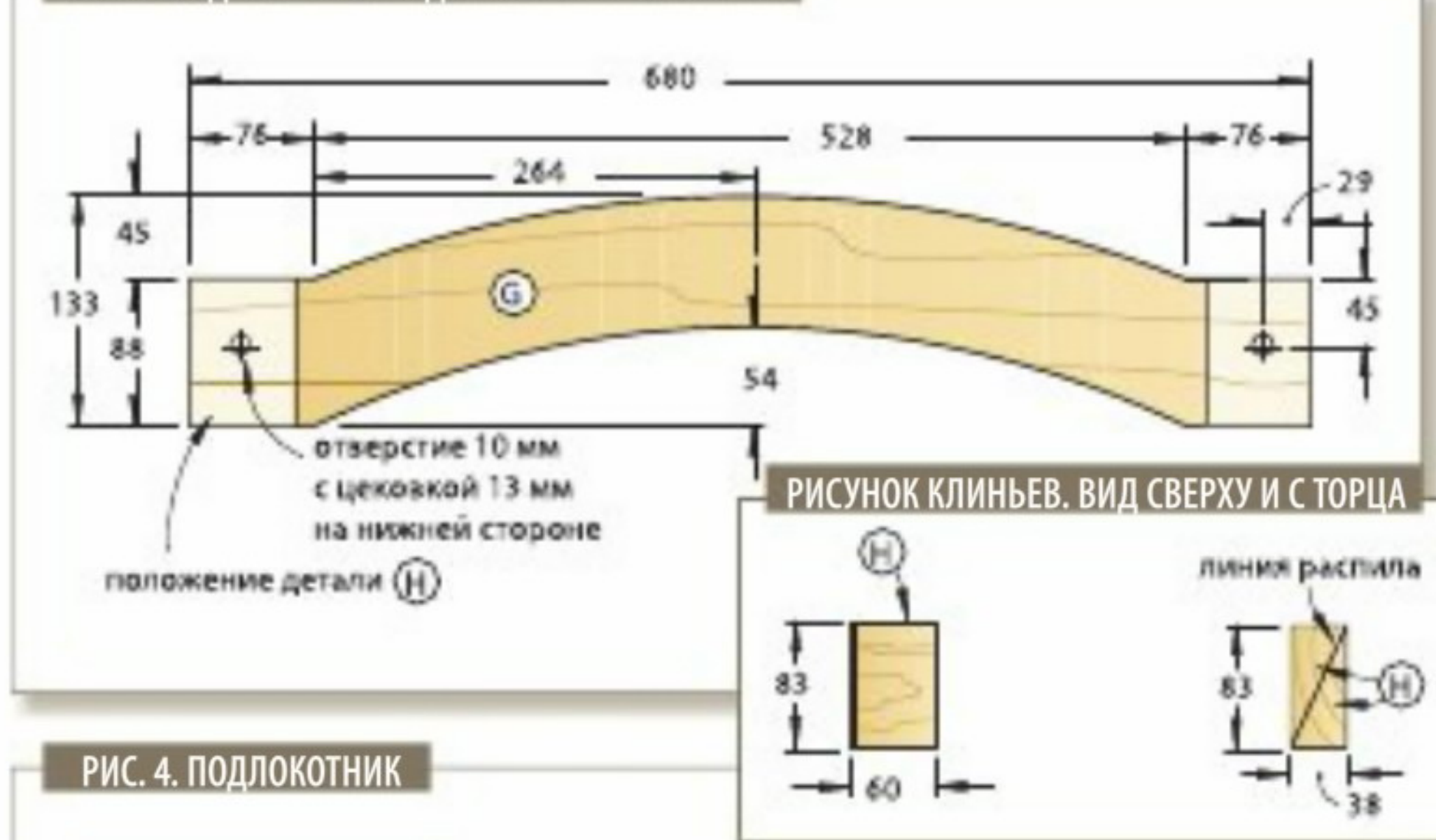
РИС. 3. ЗАДНЯЯ ПЕРЕКЛАДИНА СПИНКИ И КЛИНЬЯ
