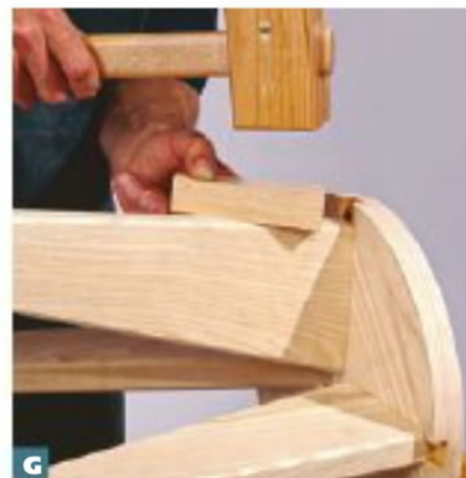
G Две ножки следует сдвинуть ближе к центру основания, чтобы надеть кольцо сверху и вставить его в вырезы.
