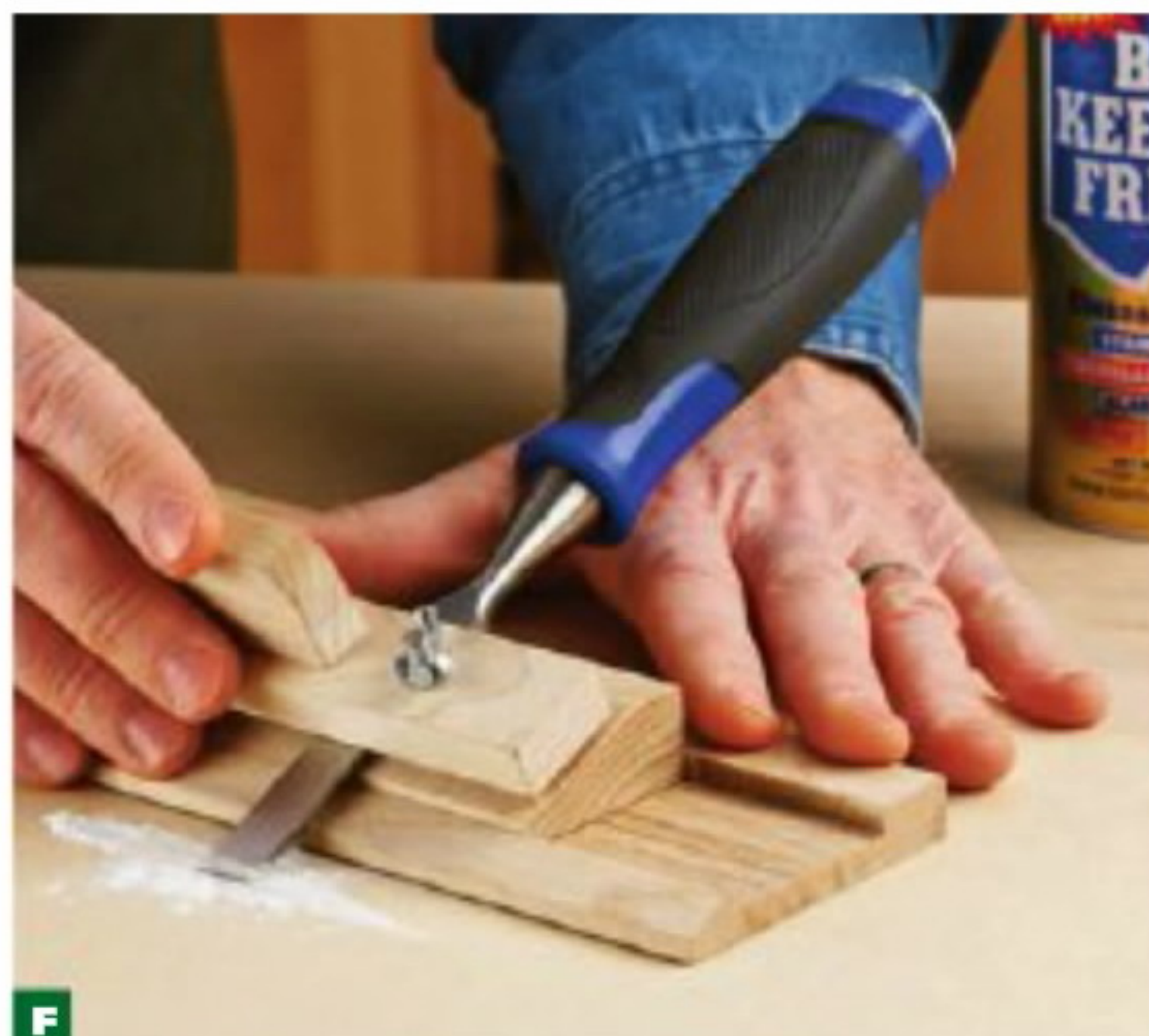
Ф Насыпьте на ровную поверхность немного абразивного порошка и действуйте так же, как на наждачной бумаге. Для окончательной полировки режущей кромки обычно хватает нескольких движений.
