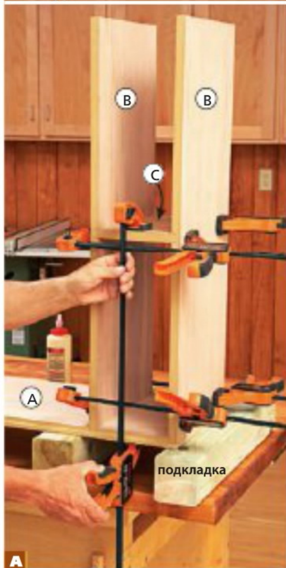
А Для удобства установки струбцин положите одну боковую стенку А верхнего корпуса на подкладки и приклейте к ней верхнюю полку, дно В и перегородку С.
