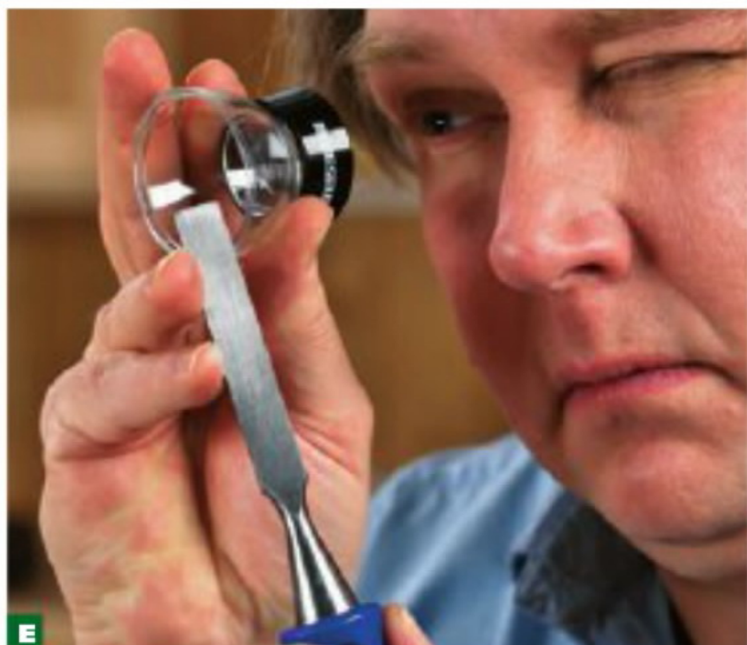
Е Большинству из нас трудно оценить качество заточки, не прибегая к помощи увеличительного стекла. Эта простая лупа с восьмикратным увеличением не загромождаёт свет, и вы можете четко увидеть все недостатки.
