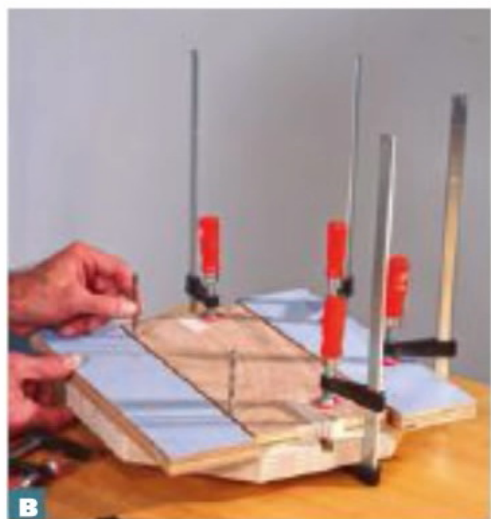
B Сделав черновые пазы, снова установите шаблон и направляющие обрезки, добавив 5-миллиметровые проставки. Удалите шаблон и отфрезеруйте шпоночный паз.
